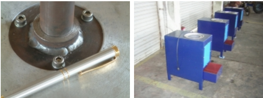
รูปที่ 7 (ซ้าย) การติดตั้งแผ่นเพลทเข้ากับแป้นขัด ใช้โบลท์ M6 สแตนเลสสตีล ติดตั้งโดยใช้แผ่น เพลทกลมจากนั้นจึงนำไปกลึงร่วมศูนย์พร้อมกัน (ขวา) แสดงลักษณะเครื่องที่ประดิษฐ์ขึ้น เมื่อทำเสร็จแล้ว
