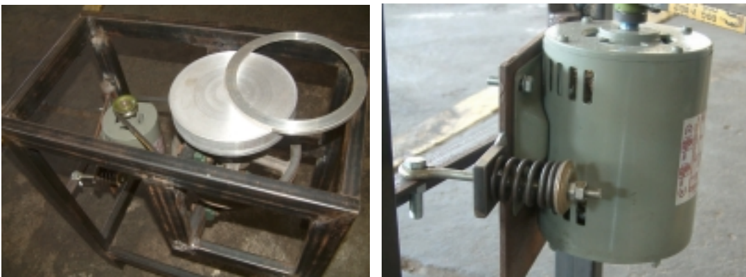
รูปที่ 5 (ซ้าย) ลักษณะการติดตั้งส่วนประกอบที่สำคัญของเครื่องที่ประดิษฐ์ขึ้น (ขวา) แสดงตำแหน่งการติดตั้งมอเตอร์และระบบดึงสายพานเพื่อลดแรงสั่นสะเทือน
