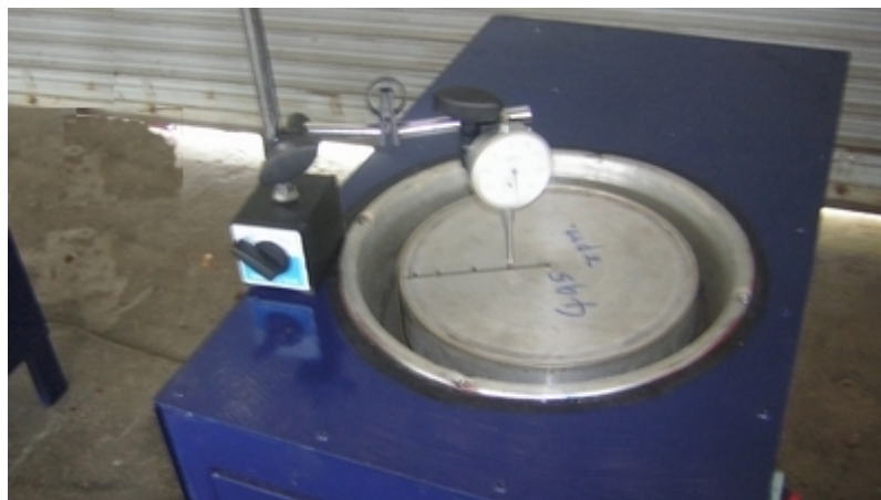
รูปที่ 1 ทดสอบความเรียบโดยใช้ Dial gauge โดยวัดจากจุดศูนย์กลางของจานขัดที่ระยะรัศมี 25, 50, 75 และ 90 มิลลิเมตร
