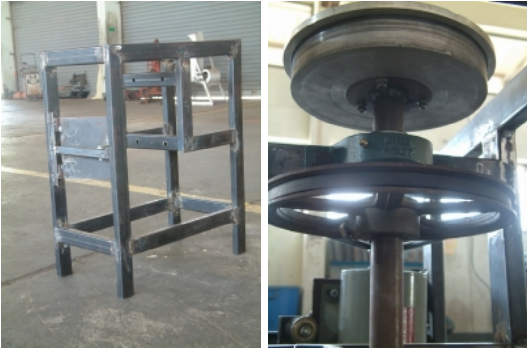
รูปที่ 5 (ซ้าย) โครงสร้างของเครื่องที่ประดิษฐ์ขึ้น (ขวา) แสดงตำแหน่งการติดตั้งล้อสายพานและแป้นขัด
