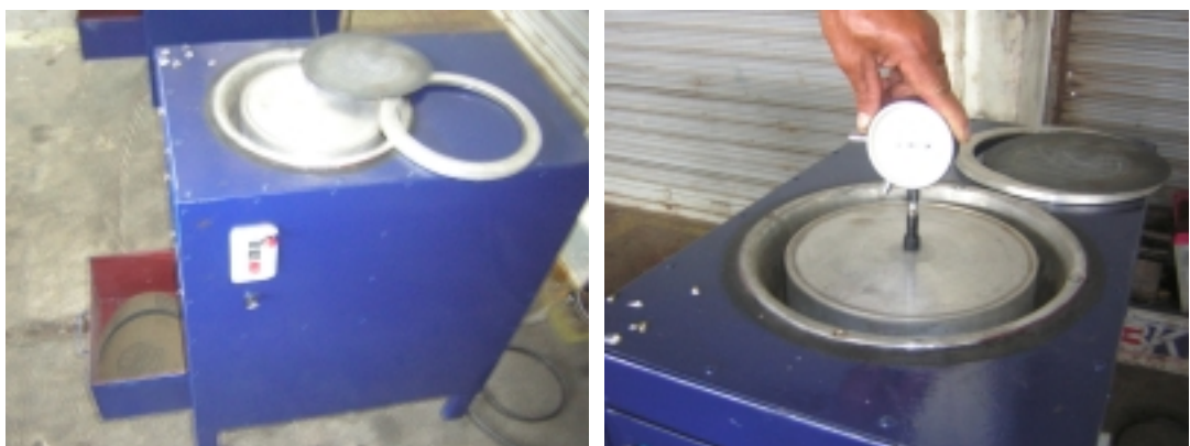
รูปที่ 8 (ซ้าย) แสดงอุปกรณ์ทั้งหมด (ขวา) การวัดรอบด้วย Hand Tachometer
